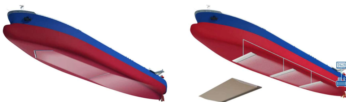
Figure 2-10 Multi-array of OceanGlide ALS (Source: Alfa Laval)
