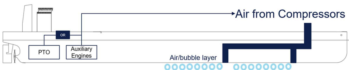
Figure 2-8 Concept of active ALS (Source: DNV)
