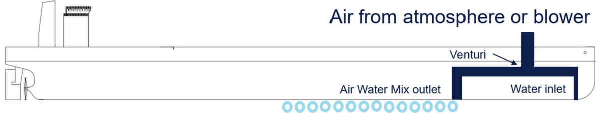
Figure 2-9 Concept of passive ALS (Source: DNV)
