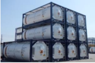
Figure 4.7 – LNG ISO containers.
